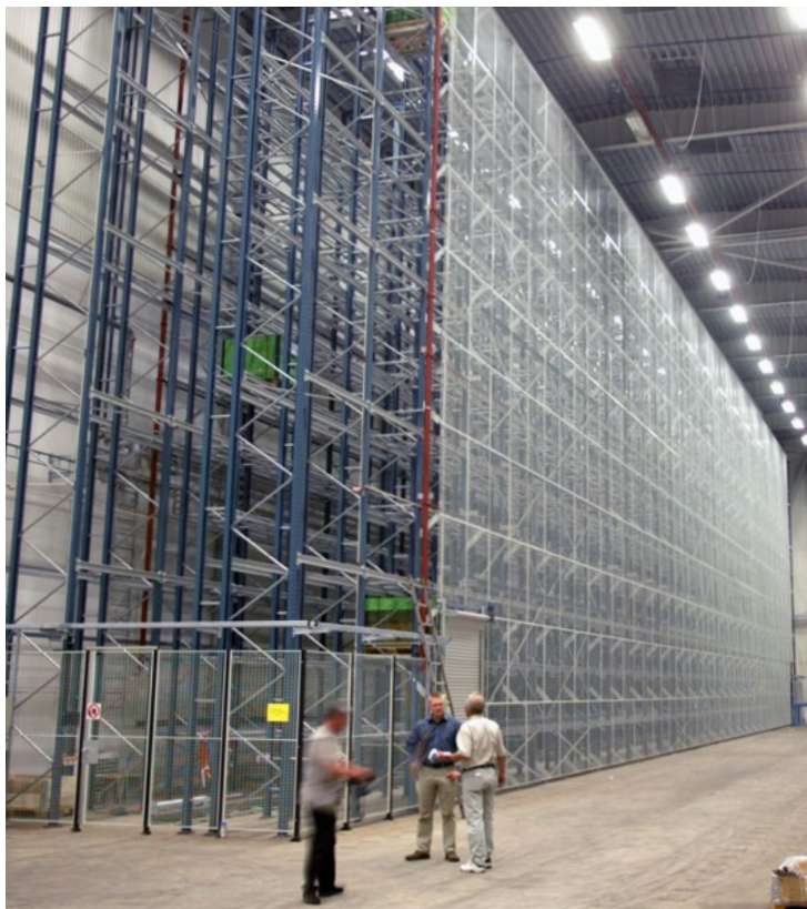
Axellent SafeStore z oczkiem siatki o rozmiarze 50x60mm. Projekt dostarczony do Scanii w Oskarshamn.
